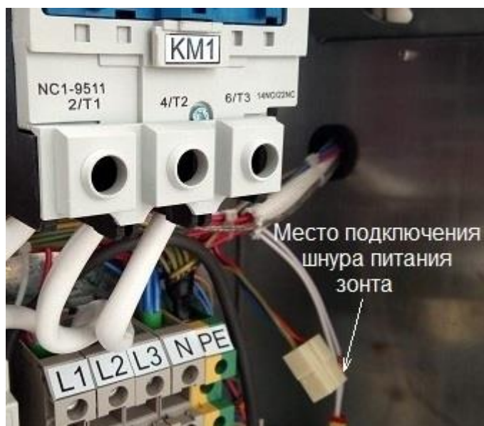
Рис.1 Подключение шнура питания зонта к колодке 45.7373.9005 пароконвектомата
